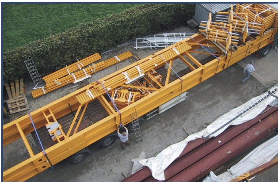
Verladen der Kranbrücken
