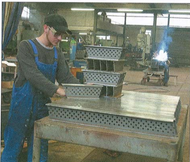
In der Fertigungshalle des Heinsberger Fachbetriebs werden DAVEX-Träger geschnitten und nach Entwürfen der Designerin Michiko Sartor zusammengefügt. Dabei ist es möglich, individuelle Kundenwünsche zu erfüllen.
