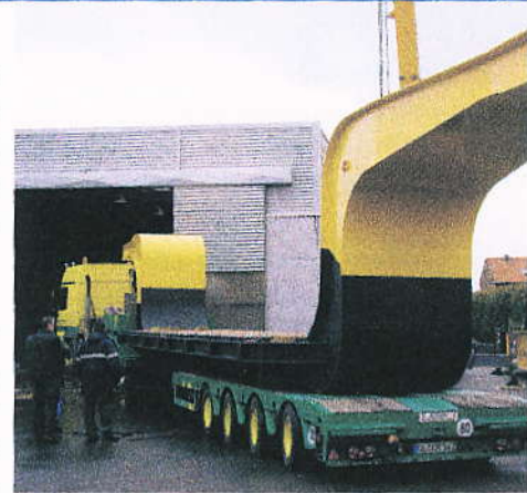
Eine Transportpalette mit einer Tragfähigkeit von 70 Tonnen fertigte Küppers für einen Energiekonzern.
