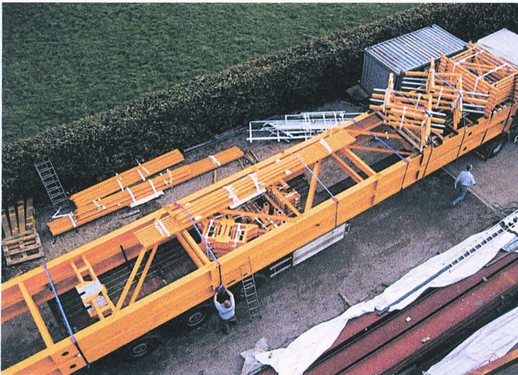
Millimetergenau musste bei der Produktion von neun jeweils 20 Meter langen Kranbrücken gearbeitet werden, von denen jede 6,5 Tonnen wiegt.
