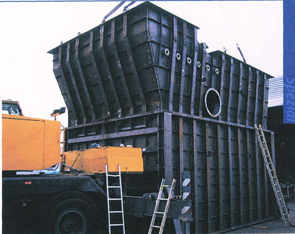
98 Tonnen wog der Wärmetauscher, den die Stahlbau Küppers GmbH für eine Müllverbrennungsanlage in Marseille produzierte.
